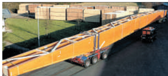
Leimbinder-Konstruktionen können riesig sein. Ende Januar wurden zehn Träger – jeweils 57,30 Meter lang und zwölf Tonnen schwer – für einen neuen Baumarkt nach Pforzheim ausgeliefert. Solche Spezialtransporte rollen nur nachts.
