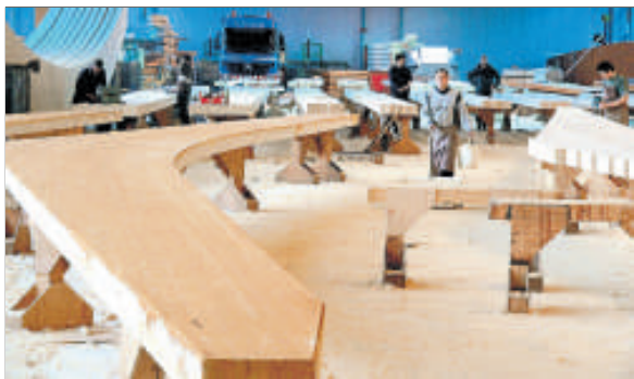
Tausende Kubikmeter Schnittholz verarbeitet Poppensieker & Derix in Velpe jedes Jahr in seiner riesigen Firmenhalle zu Leimbindern. Die Fertigung in der 18 000 Quadratmeter großen Halle unterliegt einer strengen Qualitätskontrolle.
