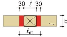
An jedem Rand in Faserrichtung des Holzes darf die Aufstandsfläche  $l$  um bis zu 30 mm verlängert werden, aber um nicht mehr als  $a$ ,  $l$  oder  $l_1/2$ .
