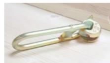
Zum Transport der X-LAM-Platten werden alternativ Kombikopf-Holzschrauben in die Seitenflächen (Decken- oder Dachelemente) bzw. Schmalflächen (Wandelemente) eingedreht. Als Lastaufnahmemittel kommen Universalkopf-Kupplungen zum Einsatz, die den Schraubenkopf umschließen und zum Krananschlag in alle Richtungen drehbar sind.
