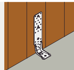
Einglassener Stoß, Vollgewindeschrauben schräg von innen
