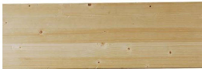
Bild 8 Mit hellem Klebstoff hergestelltes BS-Holz
