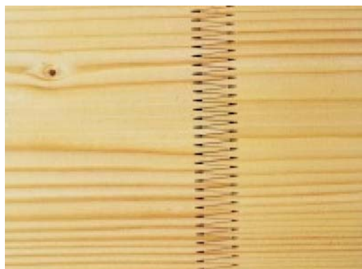
Bild 9 Keilzinkung in einer Brettschichtholzlamelle
