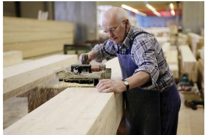
Bild 1 Oberflächenbearbeitung in einem BS-Holz-Werk
