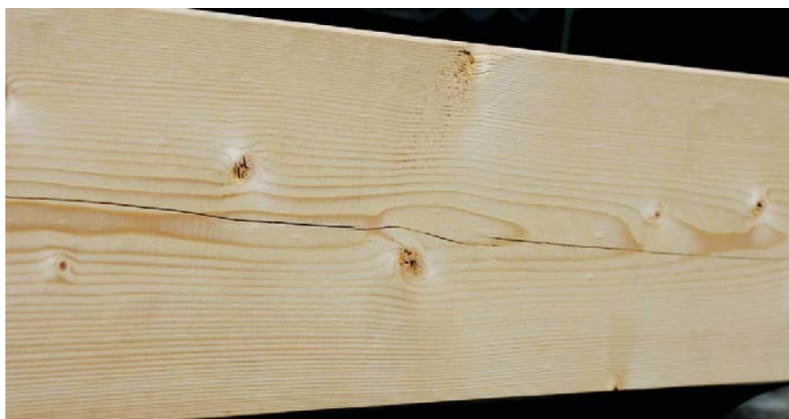
Bild 6 Schwindrisse in einer Decklamelle
